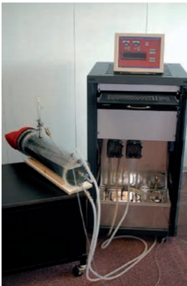
Bilde 3: Den andre generasjonen av prototypen; Vi valgte her å generere det pulserende undertrykket i Thernotuben med peristaltiske pumper i serie, noe som fungerte rimelig bra. Hovedproblemet var en svært sårbar og gammeldags software sammen med for dårlig kjølekapasitet.
